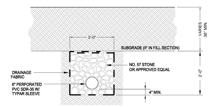
SUBSURFACE DRAIN DETAIL
