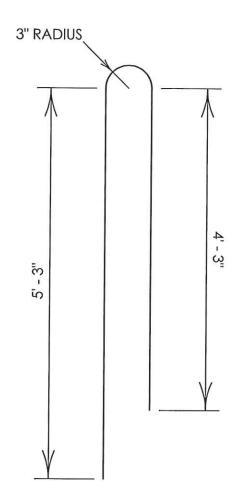
MARK A602 GALVANIZED #6 STEEL REINFORCING BAR AASHTO M31 (GRADE 60)
