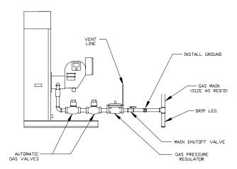
FIGURE 1.5A: GAS BURNER CONNECTION
