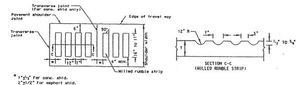
MILLED RUMBLE STRIP FOR PORTLAND CEMENT AND HOT MIX ASPHALT SHOULDERS
