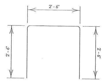
MARK A601 GALVANIZED #6 STEEL REINFORCING BAR AASHTO M31 (GRADE 60)
